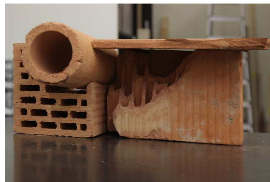
Bruchmauerwerk mit Mörtel aus Rohmasse
