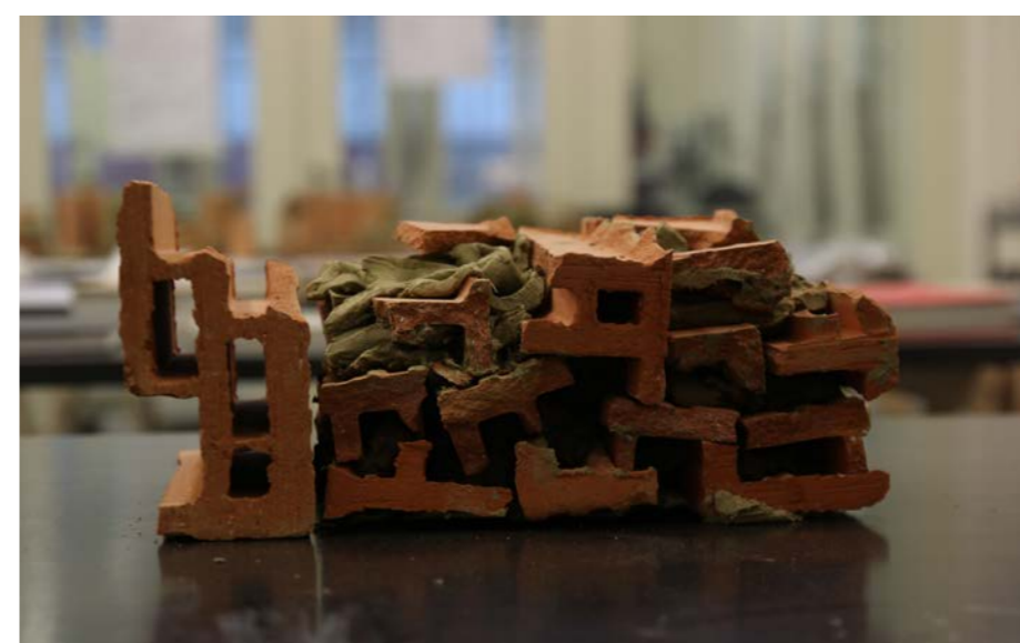
Mischmauerwerk aus gebranntem Stein und Rohmasse
